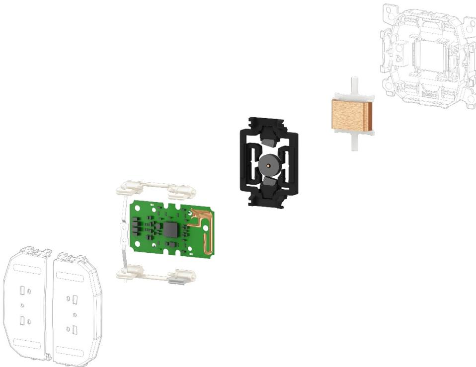
(Vue du mécanisme de récupération d'énergie intégrée à un interrupteur sans fil et sans pile)
